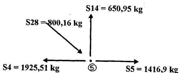
Sambungan S28 dengan S4, S5 menggunakan sambungan gigi tunggal
