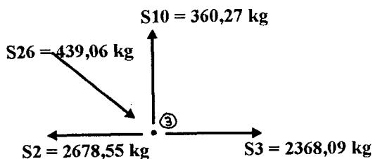
**Sambungan S26 dengan S2, S3 menggunakan sambungan gigi tunggal**
