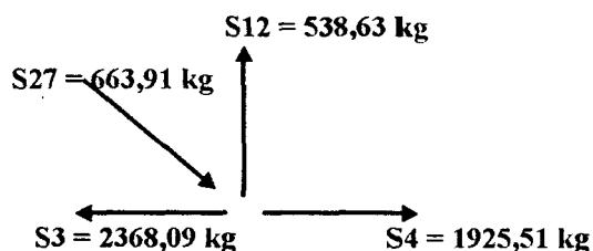
Sambungan S27 dengan S3, S4 menggunakan sambungan gigi tunggal
