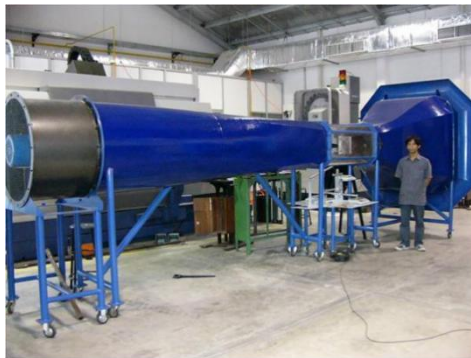
Gambar 2.13 Wind tunnel open circuit pada laboratorium fluida Petra Sumber: (Wind Tunnel Petra, 2015)
