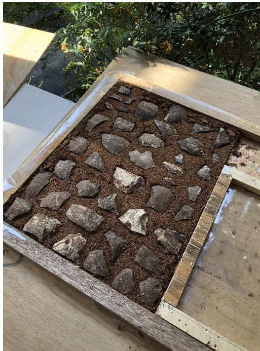
Gambar 5.12. Serbuk kayu kelapa setelah dipress bersama tempurung kelapa
