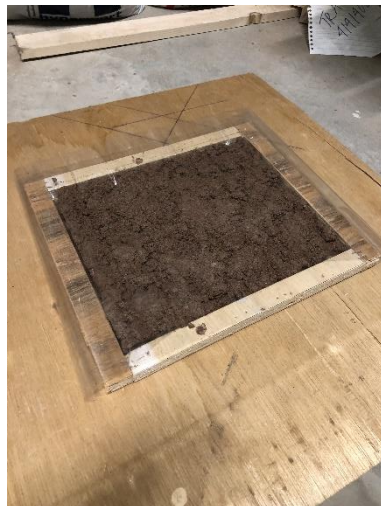
Gambar 5.11. Serbuk kayu kelapa setelah dipress
