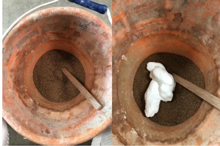
Gambar 5.8. Serbuk kayu kelapa dicampur dengan lem putih
