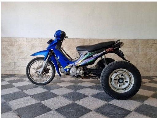
Gambar 4.2 Hasil Pembuatan Sepeda Motor Roda Tiga
