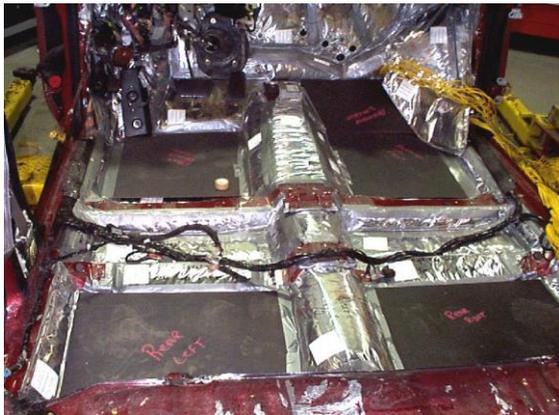
Gambar 2.4 Pelindung terbuat dari serat karbon komposit digunakan di area lantai mobil untuk melindungi *GFP* agar tidak rusak saat di injak.
