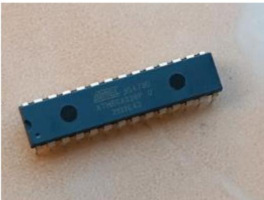
Gambar 2. 5 Chip Mikrokontroler ATmega 328
