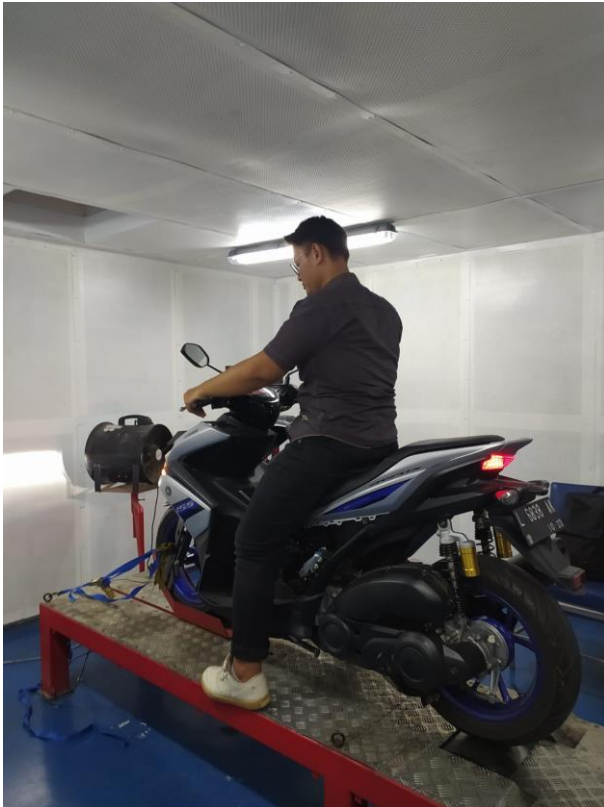
Gambar 3.2 Posisi Kendaraan Diatas Mesin Dyno untuk Proses Pengambilan Data
