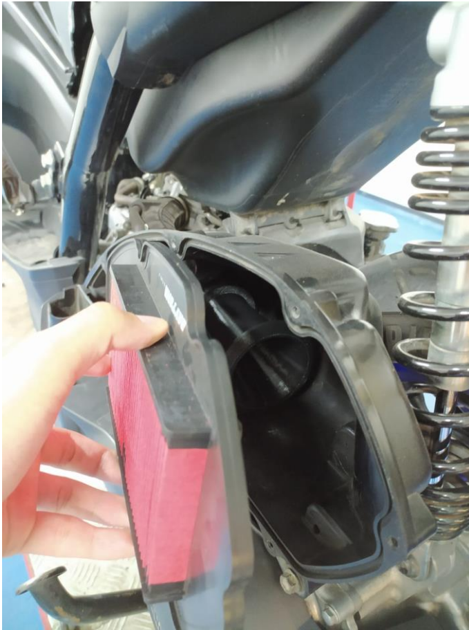
Gambar 3.7 Posisi Parameter Velocity Stack Saat Filter Udara Terpasang
