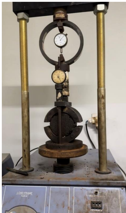
Gambar 3.15 Lakukan Pengujian Marshall
