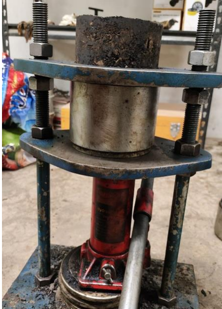
Gambar 3.6 Benda Uji Dikeluarkan dari Mold
