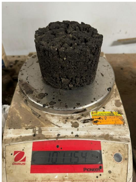
Gambar 3.13 Timbang Benda Uji Keadaan SSD
