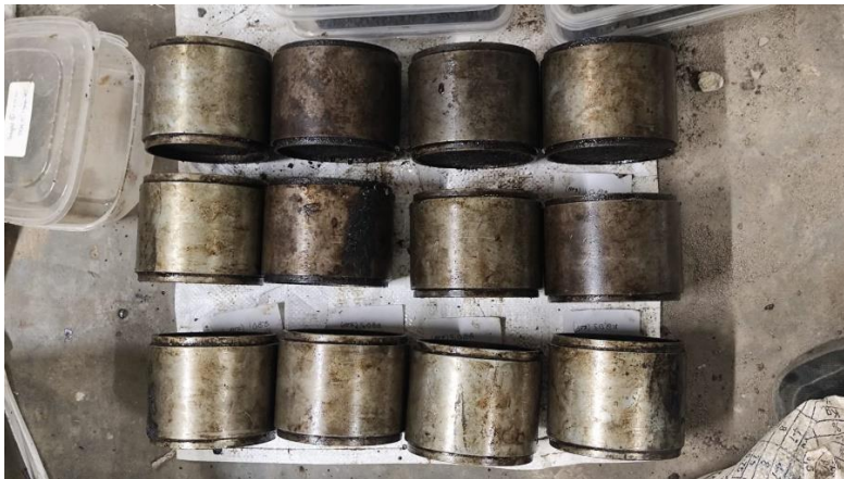
Gambar 3.5 Diamkan Benda Uji
