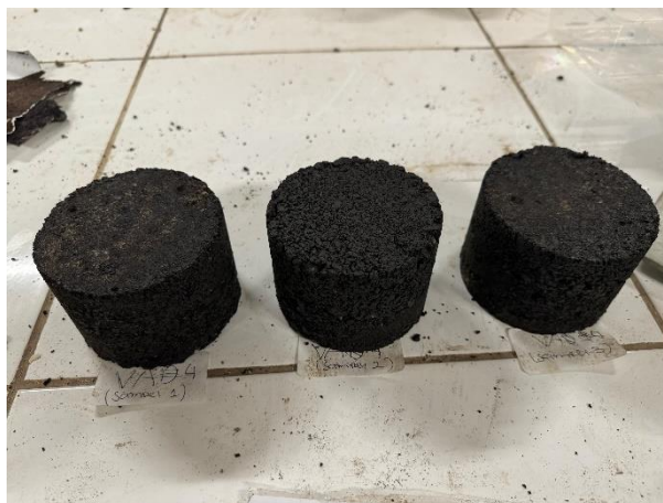
Gambar 3.9 Diamkan Benda Uji Sesuai Waktu Curing
