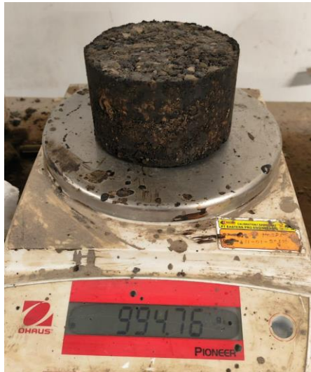
Gambar 3.8 Timbang Benda Uji untuk Mendapat Berat Udara
