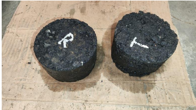
Gambar 3.12 Keringkan Permukaan Benda Uji
