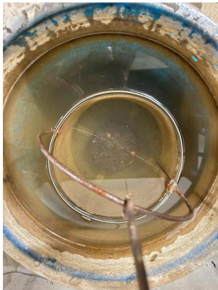
Gambar 3.11 Timbang Benda Uji Dalam Air
