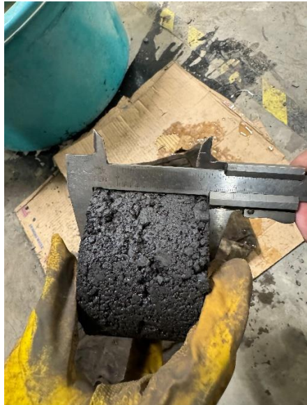
Gambar 3.14 Ukur Tinggi Benda Uji
