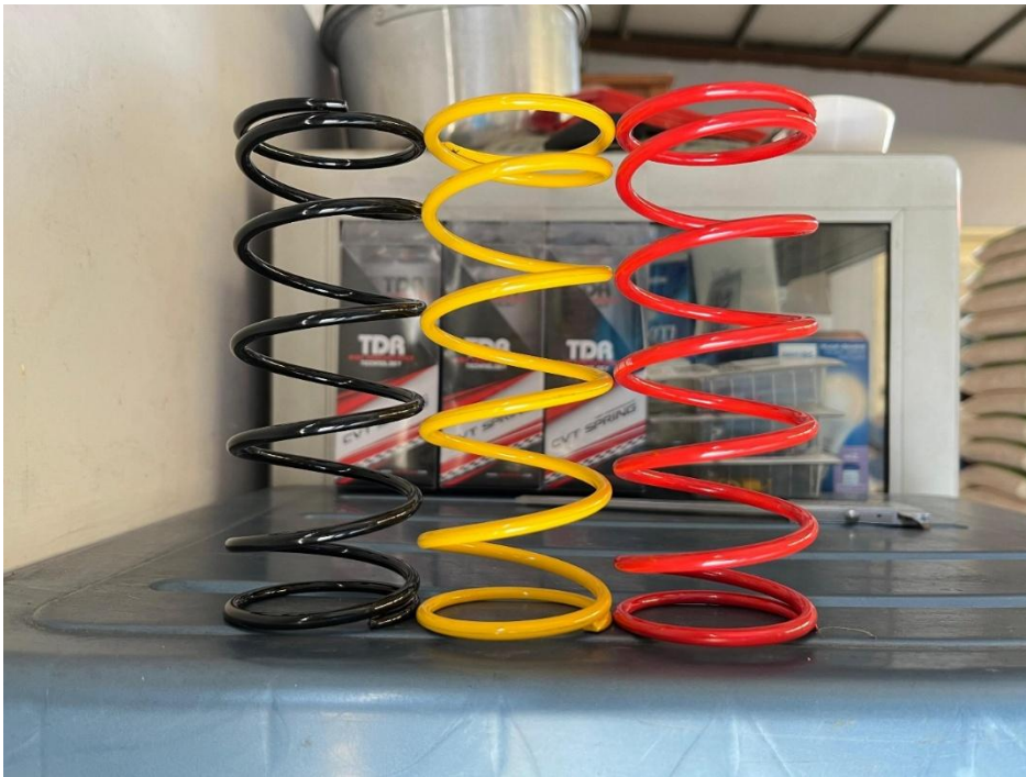
Gambar 2.4 spesimen pegas pulley dengan kelakuan 1000rpm, 1500rpm, 2000rpm
