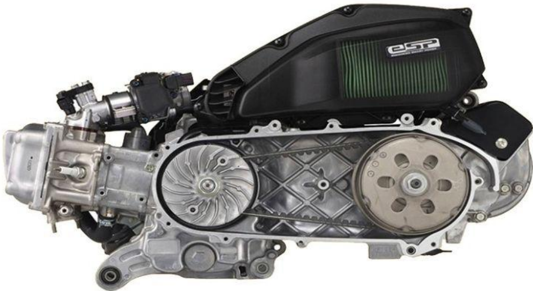
Gambar 2.1 tampak terbuka dari konstruksi transmisi cvt
