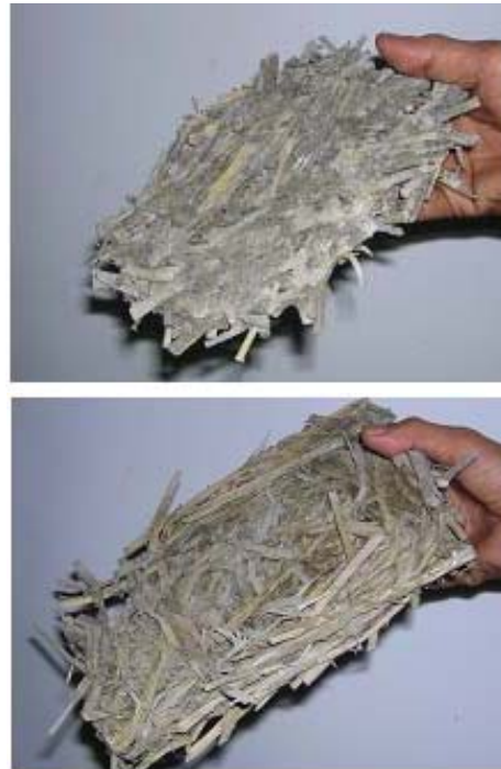
Gambar 7. Panel hasil pra-percobaan, kiri: jerami ketan dengan perekat pasta semen (semen menjadi lebih dominan), kanan: jerami IR dengan perekat semen cair encer.
