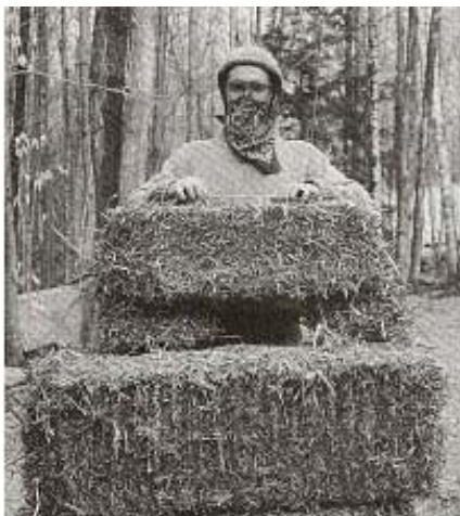
Gambar 4. Jerami gandum yang disusun kotak-kotak dan diikat untuk dimanfaatkan sebagai bahan bangunan utama (Lacinski & Bergeron 2000)
